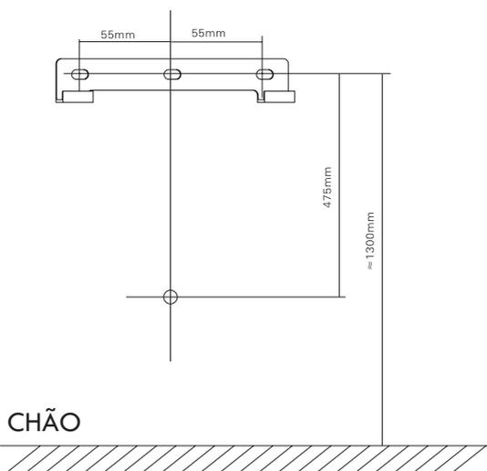
3. PENDURE O CORPO DO APARELHO NOS GANCOS QUE FORAM FIXADOS NA PAREDE.
