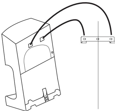
4. FIXE O CORPO DO APARELHO COM PARAFUSOS. DEPOIS, RECOLOQUE O RECEPTOR DE ÁGUA E TERMINE A INSTALAÇÃO.
